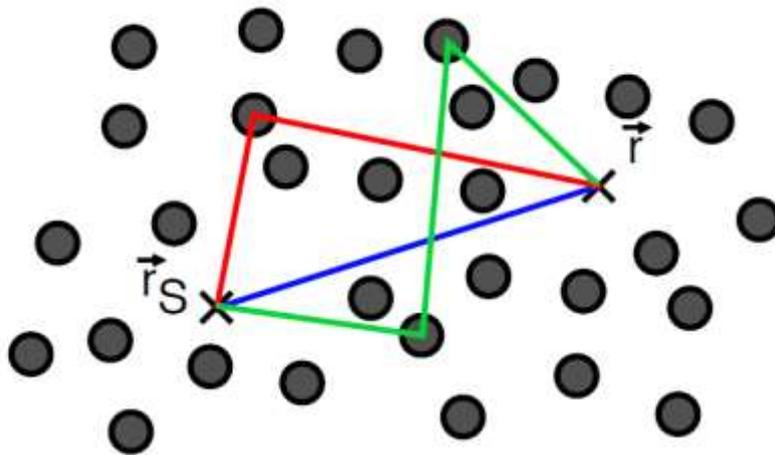
Figure 1.1 – Représentation schématique du chemin direct (bleu) et de contributions de diffusion simple (rouge) et de diffusion double (vert) entre une source  $\vec{r}_s$  et un récepteur  $\vec{r}_r$ , ponctuels, enfouis au sein d'un milieu hétérogène. Notons que deux chemins qui se croisent n'interagissent pas en régime linéaire, ce qui n'est *a priori* plus le cas en régime non linéaire.
